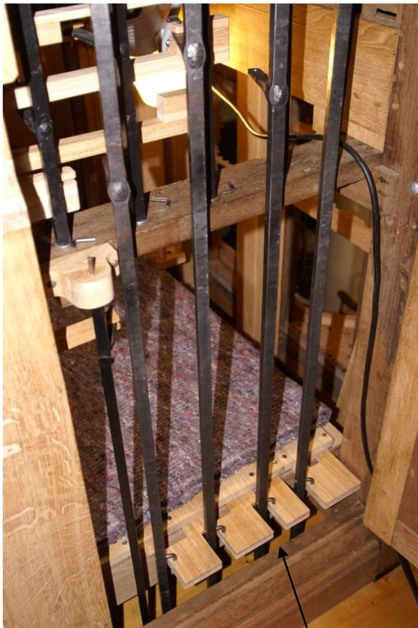
Le tirage de jeux en fer forgé, Côté droit et côté gauche de la console.
