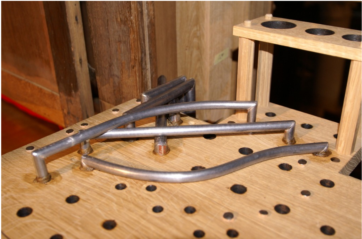
Postages en plomb pour l'alimentation des basses de Bourdon 8' et Doublette 2'.
