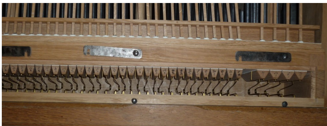
Aperçu de l'intérieur de la laye, soupapes et ressorts à boucle en laiton
