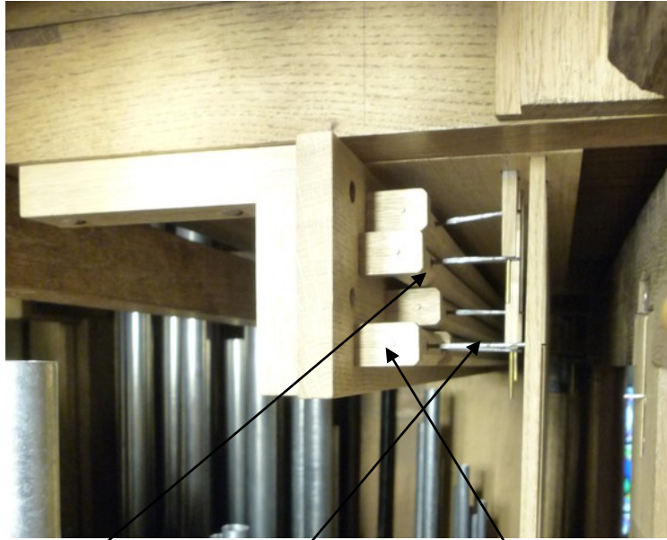
Les 4 rouleaux d'abrégé de ravalement sous le clavier de positif. Rouleaux en chêne, palettes en fer forgé, crapaudines en chêne
