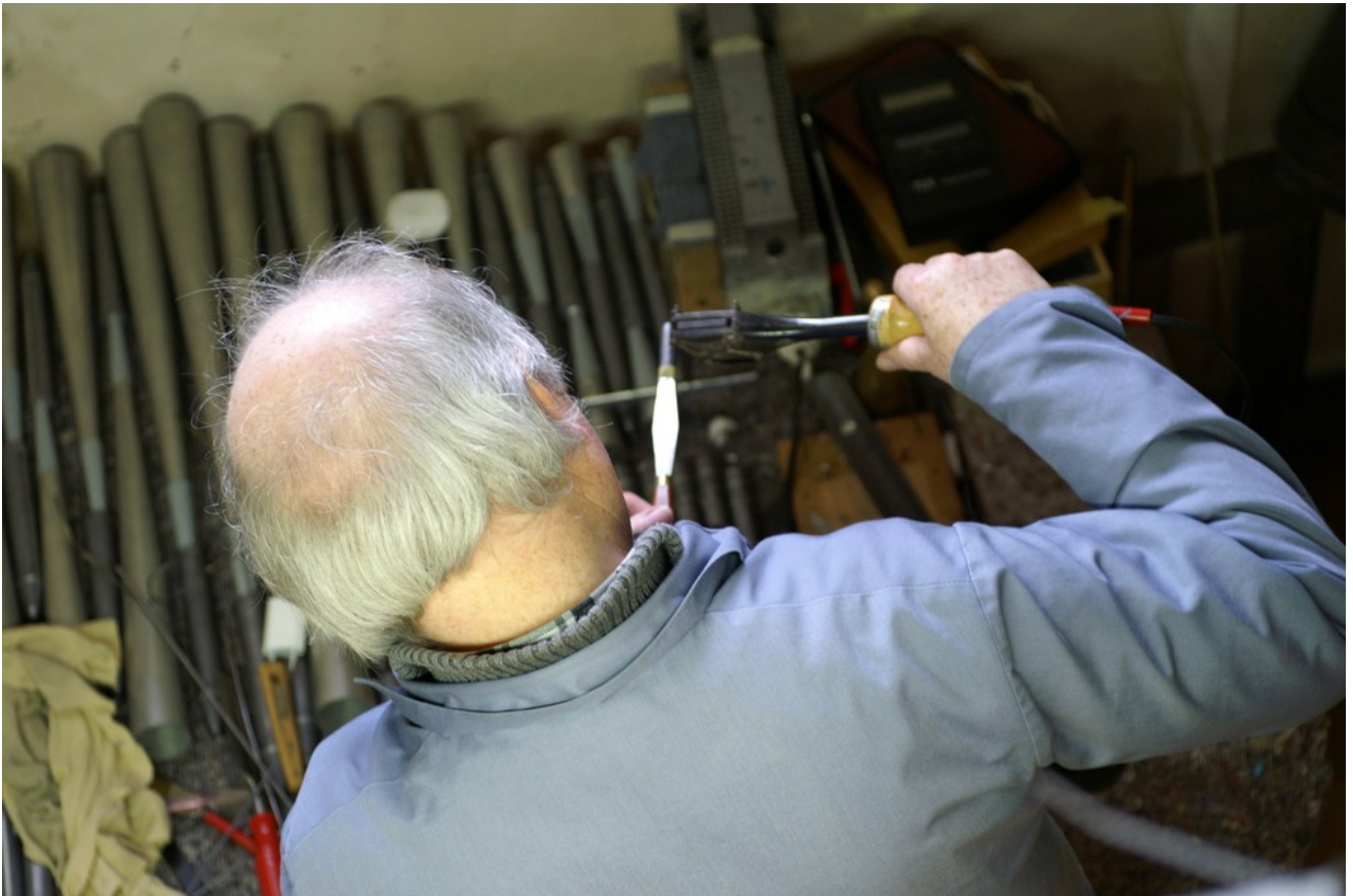
Opération délicate de rabaissement des bouches de certains tuyaux de Cornet de grand-orgue.
