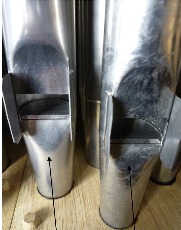
Basses de Flûte 4' Tuyaux laminés et tuyaux martelés
