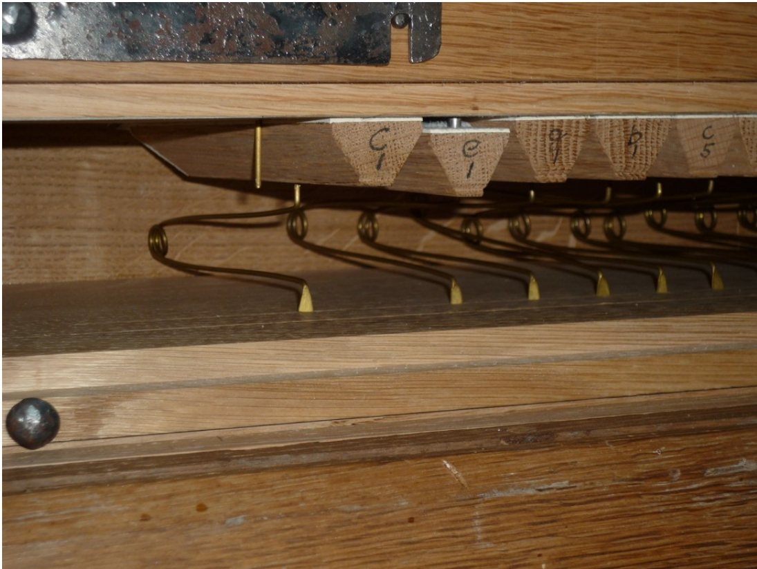
Détail de la laye: soupape en chêne ouverte, on aperçoit le pilote en noyer permettant de fouler la soupape.
