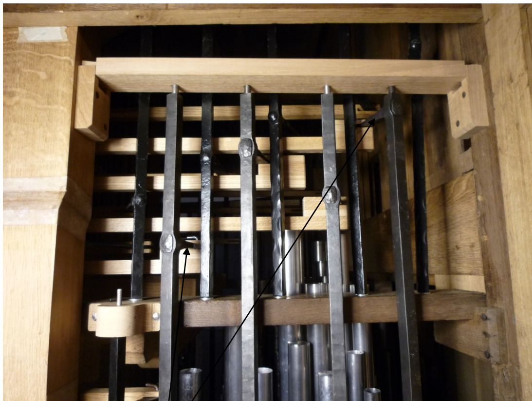
Partie supérieure des rouleaux de tirage de jeux, pattes qui vont aux tirants de la console.
