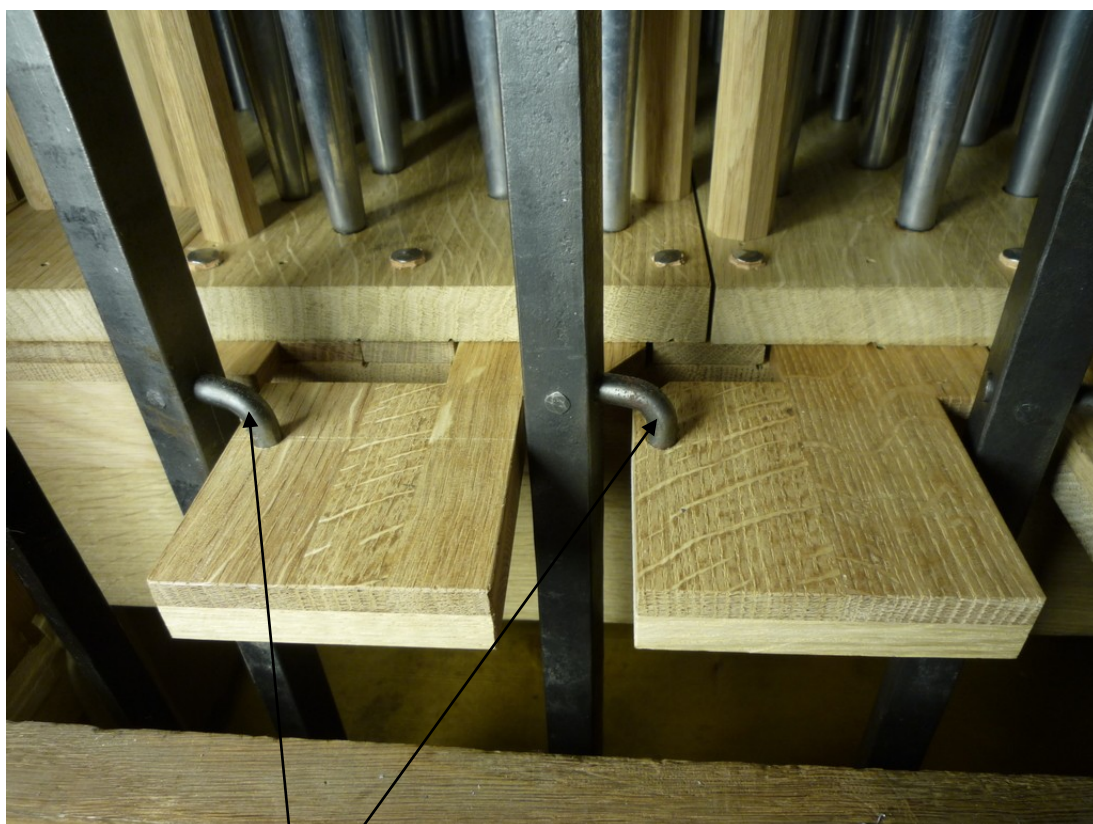
Partie inférieure des rouleaux de tirage de jeux, pattes qui vont aux registres du sommier.
